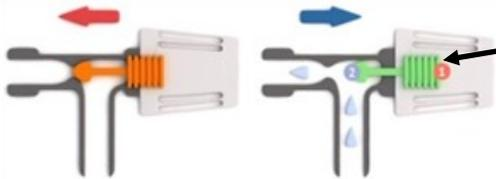
Sonde de température = **bulbe thermostatique**
